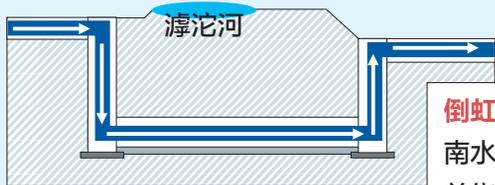
倒虹吸结构类似于倒过来的彩虹南水借助水位差可自然流淌并绕开滹沱河及周围道路
