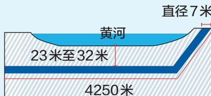
用盾构机在河底修建两条隧洞南水通过隧洞跨越黄河天堑
